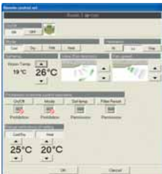
Bedienmenü für Betriebsart, Raumtemperaturen, Lüfterstufen, u.v.m.
