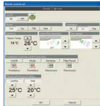
Bedienmenü für Betriebsart, Raumtemperaturen, Lüfterstufen, u.v.m.
